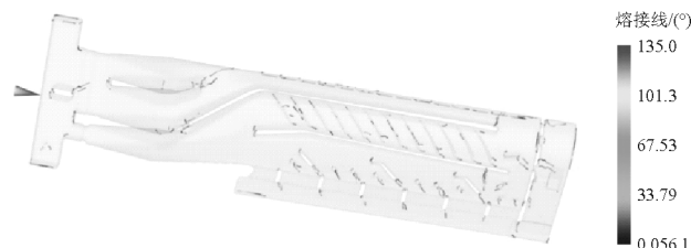
图9 陶瓷型芯在充型时形成的熔接线
