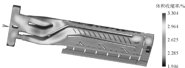
图8 计算模拟得到的平均体积收缩率
